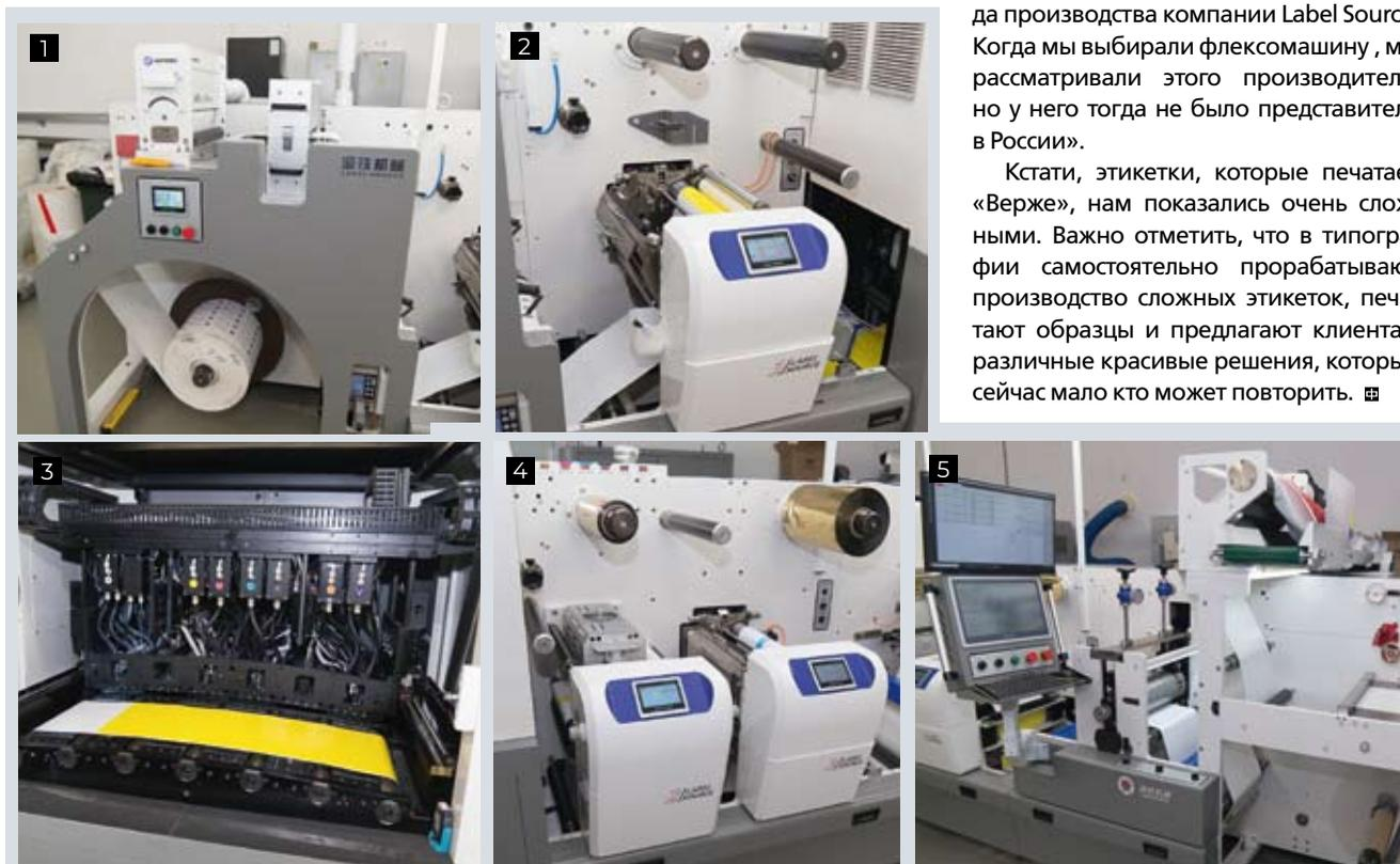
Узлы Hanlabel LabStar 330S Hybrid: 1) модуль размотки с коронатором с узлами очистки и выравнивания полотна, 2) флексо секция с возможностью ламинации и нанесения холодной фольги до модуля цифровой печати, 3) модуль цифровой печати печатает белилами, СМУК и наносит лак-клей для цифровой фольги 4) модуль полуротационной высечки и удаления обложки, 5) модуль нанесения фольги на струйный лак-клей и еще одна флексосекция
