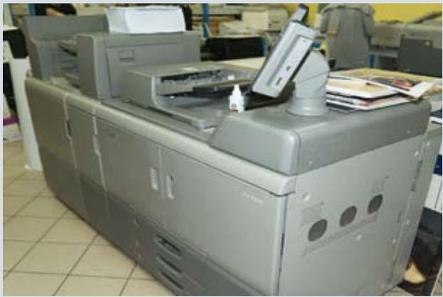
ставщик заменил длинную кассету на более короткую — с возможностью печати баннеров длиной до 700 мм.
