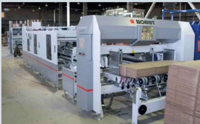
Современный этап развития связан с приобретением высокопрофессиональной техники BOBST: флексографской машины для печати по гофрокартону VISIONLINE с пристыкованным вырубным прессом VISIONCUT (вверху), а также фальцесклеивающей машины EXPERTFOLD для гофрокартона с шириной заготовки до 230 см (внизу)
