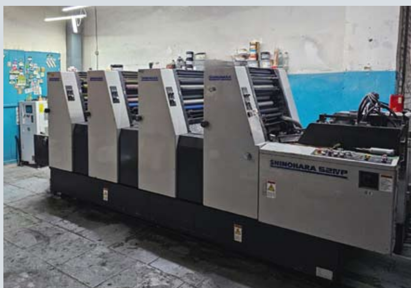
Четырехкрасочная офсетная машина Shinohara 52-4 позволила типографии расширить возможности по печати этикетки на металлизированной бумаге
