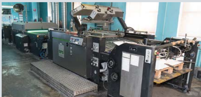
Оборудование для декорирования переплетных крышек: тиснение фольгой по покровному материалу, трафаретная линия для выборочного лакирования
