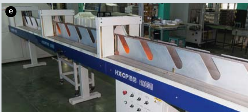
Модули блокообработывающей линии HX6000 компании HX-CP: а) подача блока, б) трехэтапный обжим блока, в) модуль формирования потока блоков, г) форзацприклеечная машина, д) модуль заклейки корешка и окантовки блока, е) сушка корешка, ж) модуль сопряжения с последующим оборудованием
