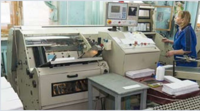
Книги в твердом переплете нужно шить, поэтому на комбинате внушительное количество ниткошвейных и фальцевальных машин
