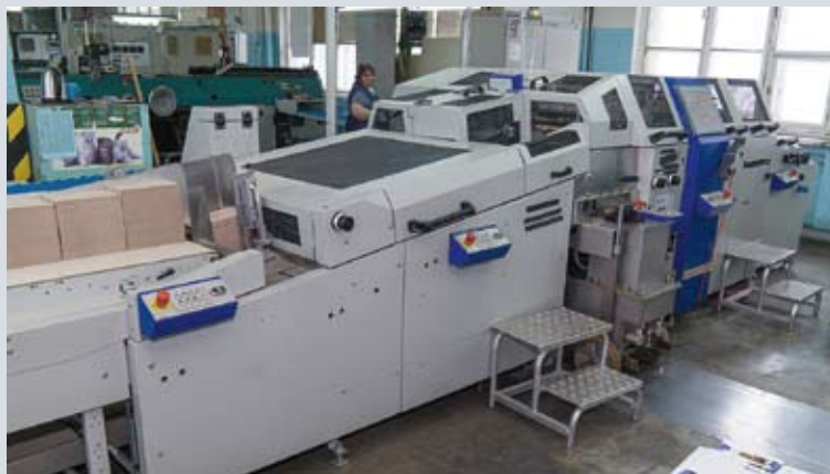
На комбинате большой парк крышкоделательного оборудования (вверху) и прессов для тиснения по переплетным крышкам (слева)
