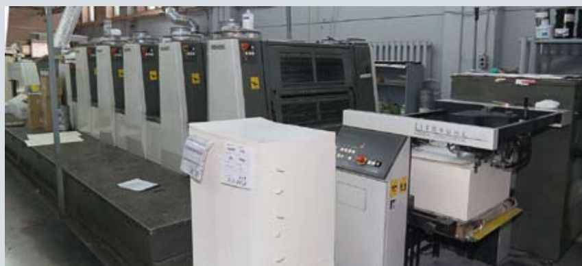
Печатный парк типографии «Альтиора» в настоящее время состоит из двух листовых печатных машин Komori Lithrone 29, одна из которых подготовлена под печать высокорезактивными красками и имеет сушильный модуль H-UV
