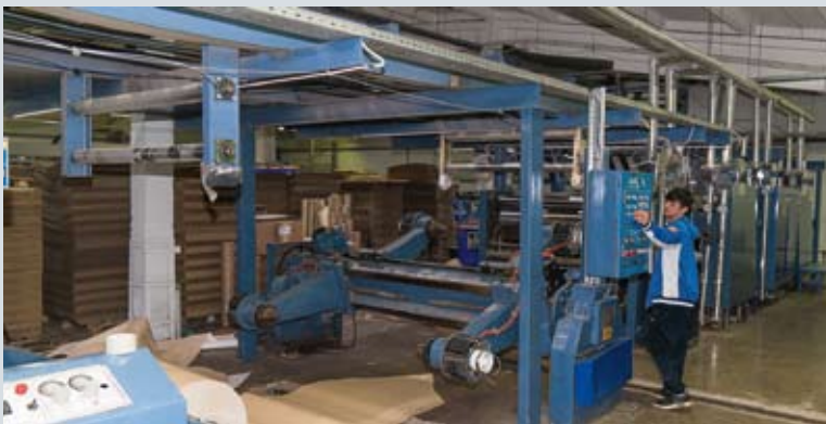
Собственный гофроагрегат – основа бизнеса «Калькулэйт». Для получения декорированного гофрокартона используются две кашировальные машины
