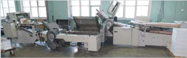
Книги в твердом переплете нужно шить, поэтому на комбинате внушительное количество ниткошвейных и фальцевальных машин
