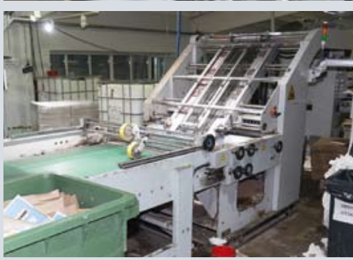
Собственный гофроагрегат – основа бизнеса «Калькулэйт». Для получения декорированного гофрокартона используются две кашировальные машины
