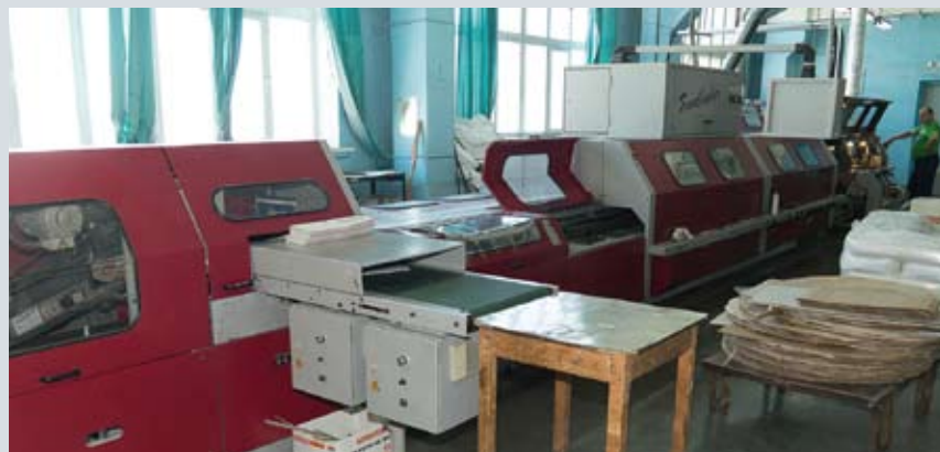
Блоки, сделанные на линии НХ6000, попадают на книгоставочную линию Kolbus (вверху). Внизу линия бесшвейного скрепления Muller Martini
