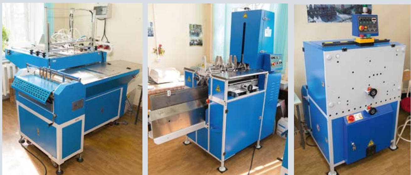
Комплекс оборудования для твердого переплета MauFung состоит из крышкоделательной машины (слева), книговставки (в центре) и прессовально-обжимной машины (справа)
