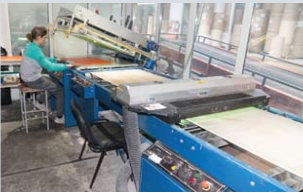
Для отделки оттисков используется трафаретная печать (или трафаретное лакирование) и ламинация
