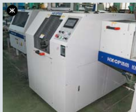
Модули блокообработывающей линии HX6000 компании HX-CP: а) подача блока, б) трехэтапный обжим блока, в) модуль формирования потока блоков, г) форзацприклеечная машина, д) модуль заклейки корешка и окантовки блока, е) сушка корешка, ж) модуль сопряжения с последующим оборудованием
