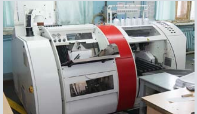
Книги в твердом переплете нужно шить, поэтому на комбинате внушительное количество ниткошвейных и фальцевальных машин
