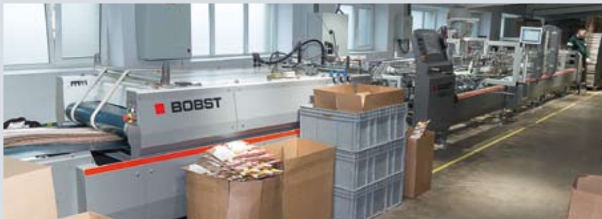
Для высечки и фальцовки-склейки используется оборудование компании Bobst
