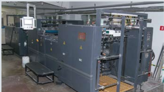
Для отделки оттисков используется трафаретная печать (или трафаретное лакирование) и ламинация
