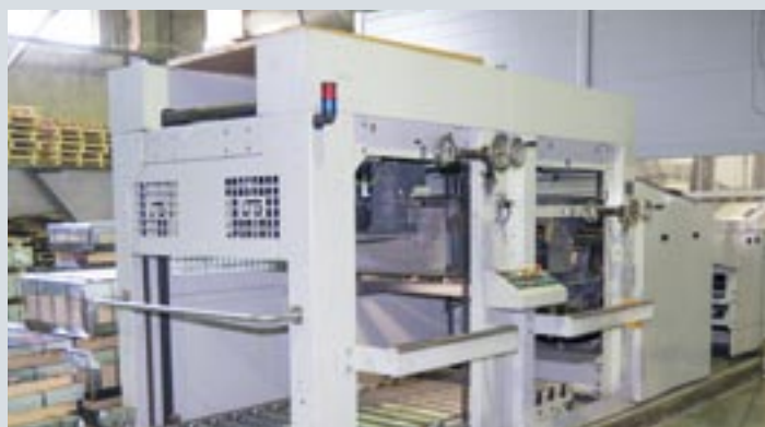
Комплект специального оснащения печатной машины для работы с листовой жестью: вверху — блок окончательных УФ-сушильных устройств (есть и промежуточные), внизу — самонаклад для подачи листов жести и двойной приемный стекер с возможностью автоматического выброса листа для контроля печати
