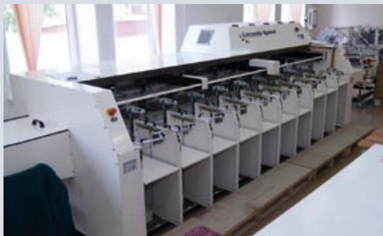
Оборудование для подборки и шитья продукции проволокой. Листоподборочная линия Lasonda была установлена компанией «ЯМ Интернешнл»
