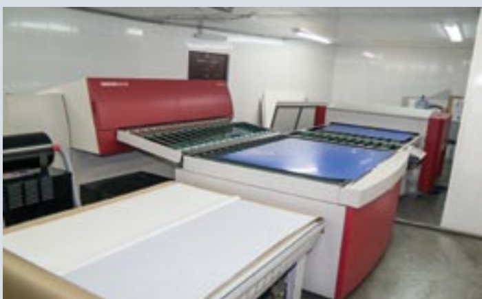
Для изготовления печатных форм используется выводное устройство Agfa Avalon N16 и формные пластины производства Agfa
