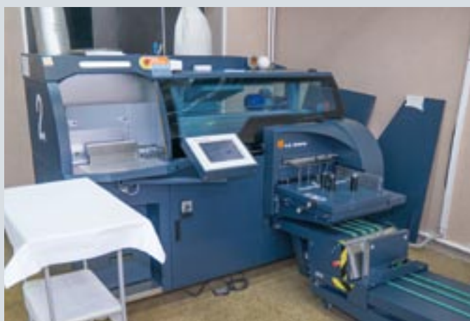
В типографии разнообразие послепечатного оборудования. На фото устройство для бесшвейного скрепления и ниткошвейная машина. На фото справа фальцевальная машина...
