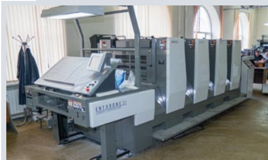
Основу печатного парка типографии «Росинформагротех» составляют японские печатные машины Komori. Первая — Sprint 228 — была установлена в начале 2009 г., вторая — четырехкрасочная Komori Entrone 29 — смонтирована в начале 2015 г.
