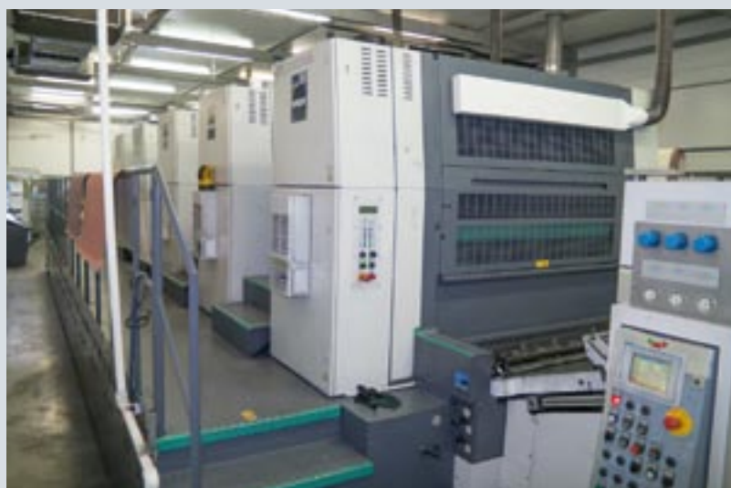
Основное оборудование типографии «Печатные Технологии»: вверху — лакировальная линия с газовой сушкой для нанесения покрытий на листовую жести, внизу — печатная машина для печати на листовой жести на базе печатной машины Roland 900
