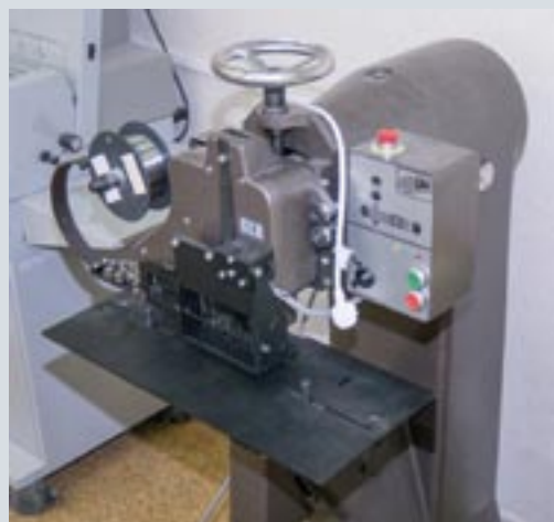
Оборудование для подборки и шитья продукции проволокой. Листоподборочная линия Lasonda была установлена компанией «ЯМ Интернешнл»
