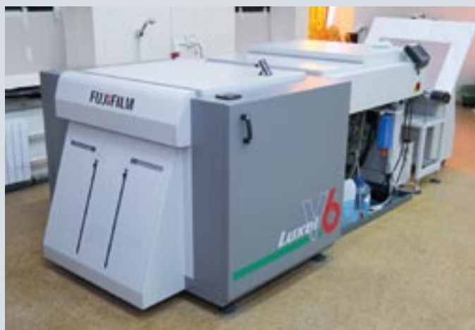
Все допечатные процессы в типографии построены на технологиях FUJIFILM: система прямого вывода форм — Luxel V6, формные пластины — FUJIFILM Pro-V Lo-chem
