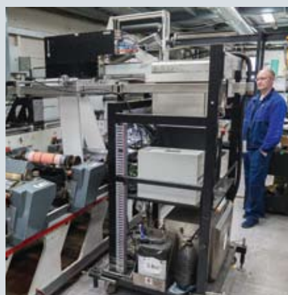
В «Солви Пак» сейчас работает две флексографских печатных машины: Nilpeter SB и Omet XFlex 4. Omet в дополнение оснащена секцией цифровой струйной печати для влечатывания кодов «Честный Знак» (фото справа внизу)
