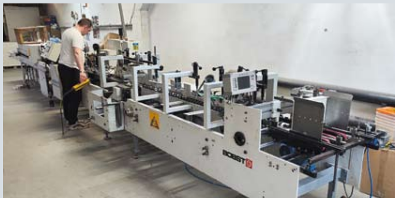
«Упаковочное» оборудование типографии состоит из нового пресса Dayuan и бывшей в употреблении фальцесклейки
