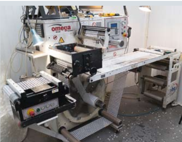
Бобинорезки для разрезки отпечатанных рулонов на отдельные ручки, шириной в одну этикетку
