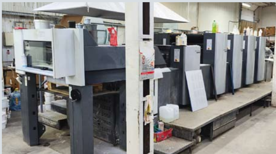
В настоящее время в «СильверПринт» для печати используется четырехкарочная с лакировальной секцией полуформатная печатная машина Heidelberg Printmaster 74
