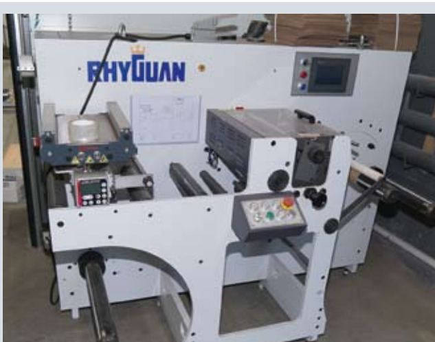
Бобинорезки для разрезки отпечатанных рулонов на отдельные ручки, шириной в одну этикетку
