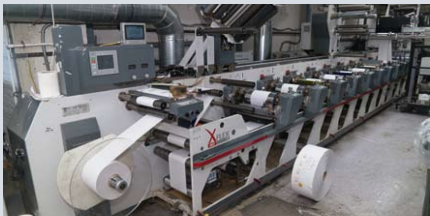
В «Солви Пак» сейчас работает две флексографских печатных машины: Nilpeter SB и Omet XFlex 4. Omet в дополнение оснащена секцией цифровой струйной печати для влечатывания кодов «Честный Знак» (фото справа внизу)
