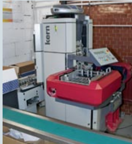
Линия для вложения в конверт почтовых отправок понадобилась в тот момент, когда с увеличением объема заказов комплектовать их вручную стало уже сложно
