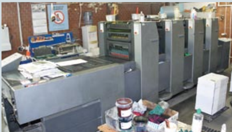
Чтобы иметь возможность самостоятельно изготавливать рекламные вложения, «Экспресс-Реклама» приобрела двух- и четырехкрасочную машины Heidelberg. Офсетное оборудование лучше всего подходит для печати больших тиражей печатной продукции
