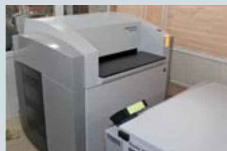
СтР-устройство Heidelberg для изготовления печатных форм необходимо было для создания производства полного цикла
