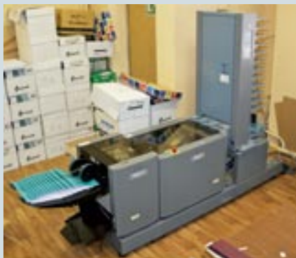
В типографии МГПУ в основном изготавливают книжно-журнальную продукцию. Для этого имеется все необходимое после-печатное оборудование. Многополосные издания скрепляются на ПУР-клей
