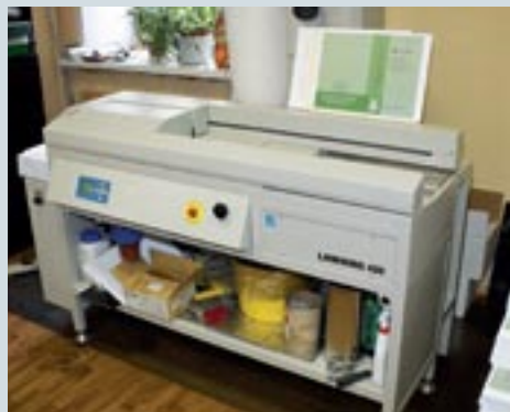
В типографии МГПУ в основном изготавливают книжно-журнальную продукцию. Для этого имеется все необходимое после-печатное оборудование. Многополосные издания скрепляются на ПУР-клей
