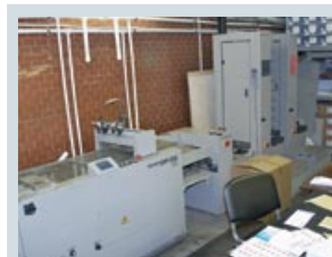
Листоподборочная линия применяется для изготовления многополосных изданий
