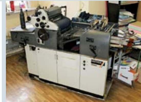
Для печати тиражных работ в типографии применяют однокрасочную офсетную машину Hamada или ризограф для производства изданий в одну краску
