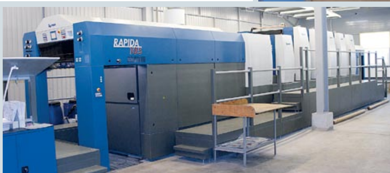
В типографии «Полиграф Принт» не так давно установлена печатная машина KBA Rapida 105 в гибридном исполнении с секцией лакирования
