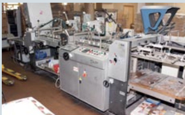
Среди прочего, в типографии используется и уникальная фальцевально-склеивающая линия Fidia, позволяющая выполнять большой объем самых разных работ по фальцовке, склейке, приклейке и т.д.
