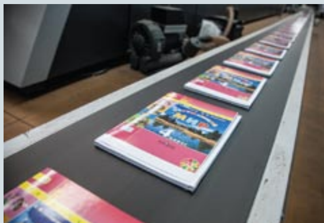
Новая линия бесшвейного скрепления обладает высокой производительностью, позволяющей оперативно склеивать как длинные, так и сверхкороткие тиражи книжной продукции
