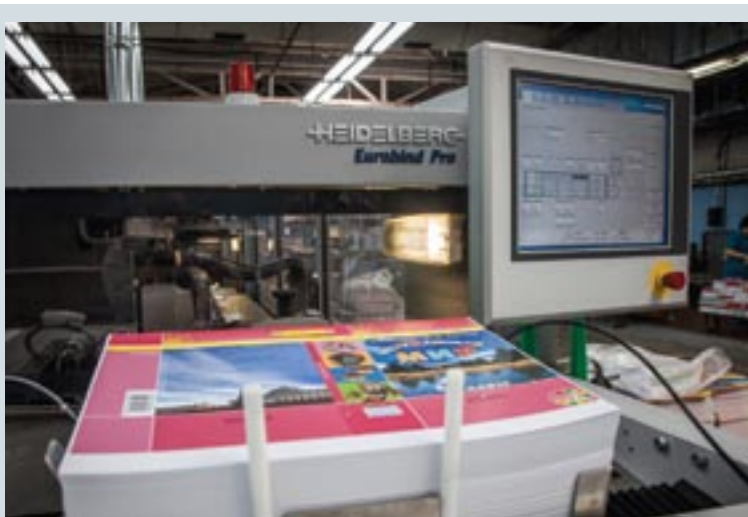
Линия Eurobind оснащена пультом управления для упрощения и ускорения работы на оборудовании
