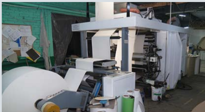
Рулонная офсетная машина используется для печати черно-белой продукции, а также для производства цветной бумаги. Недавно типография приобрела флексографскую машину (внизу), которая лучше подходит для «окрашивания» бумаги (получаются более насыщенные цвета)
