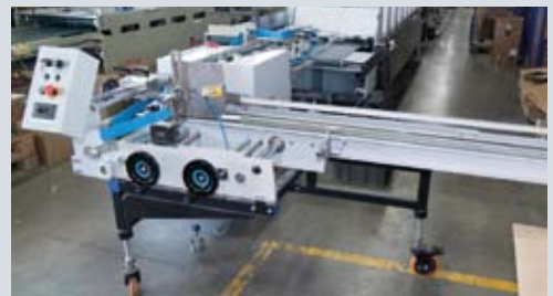
Устройство EastPacker позволяет сократить число приемчиков на фальцевально-склеивающей линии
