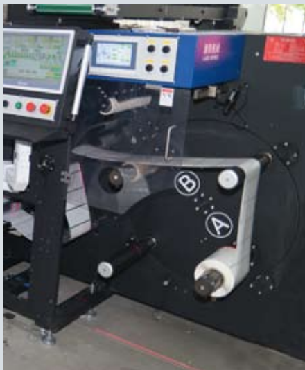
Система автосклейки рулонов на подаче (слева) и непрерывная турельная намотка
