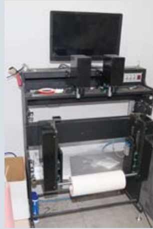
Бобинорезальная машина для резки джамбо-рулонов самоклейки на формат и автоматизированный станок для монтажа флексографских форм
