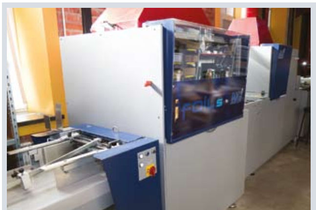
Машина MGI JetVarnish 3Ds Foil для цифровой декоративной отделки оттисков фольгой и объемным лаком
