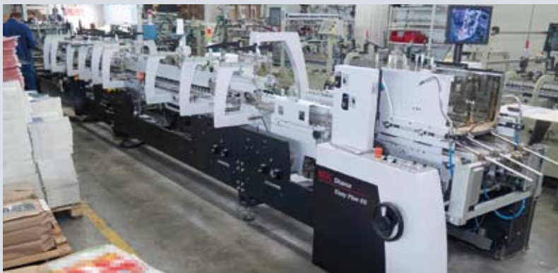
Устройство EastPacker позволяет сократить число приемчиков на фальцевально-склеивающей линии
