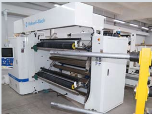
Бобинорезальная машина для резки джамбо-рулонов самоклейки на формат и автоматизированный станок для монтажа флексографских форм
