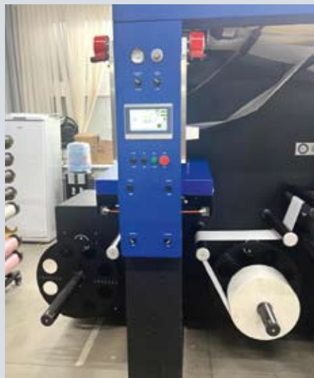
Система автосклейки рулонов на подаче (слева) и непрерывная турельная намотка
