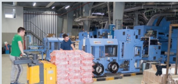
Отпечатанные газеты по потолочному транспортеру могут автоматически подаваться либо на промежуточное хранение, либо на линии комплектования, либо на приемные стекеры (фото справа), которые формируют готовые к дистрибуции комплекты
