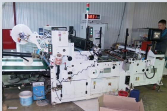
Есть в типографии и весьма редкое оборудование, в частности, линия для каландрирования оттисков и машина для вклеивания окошек из разных полимерных материалов
