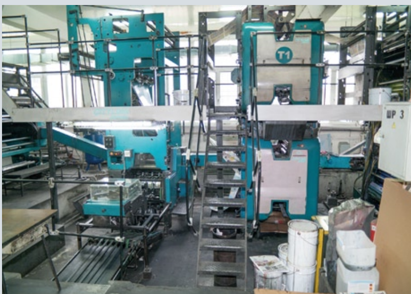
Для печати газет в «Волоколамской типографии» была установлена печатная машина Cityline Express от Manugraph
