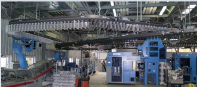
Отпечатанные газеты по потолочному транспортеру могут автоматически подаваться либо на промежуточное хранение, либо на линии комплектования, либо на приемные стекеры (фото справа), которые формируют готовые к дистрибуции комплекты
