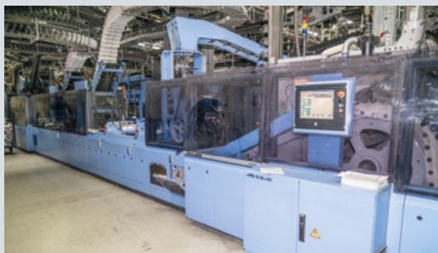
Комплектование газет из отдельных тетрадей и вложений проводится автоматически на линиях комплектования FlexiLiner и ProLiner от компании Muller Martini
