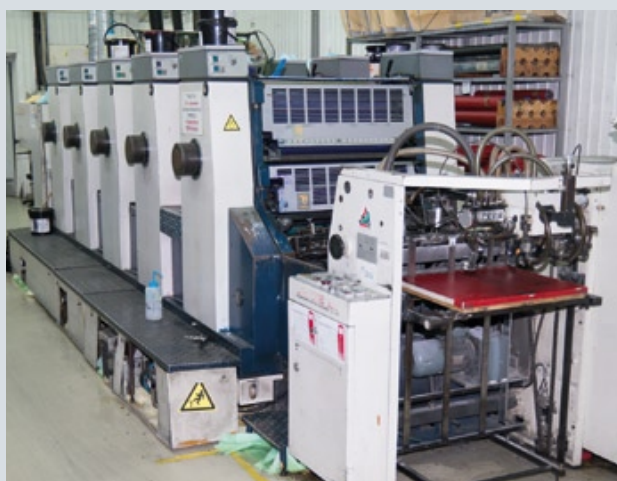
Все печатные машины НоваКарт Komori. Слева внизу — одна из первых машин Komori Lithrone 526, купленная еще в начале работы компании в новом здании, но и сейчас она активно используется
