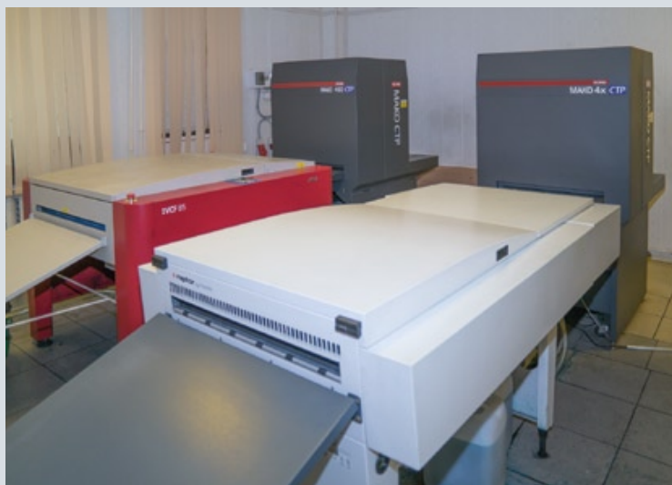
Для изготовления печатных форм в типографии установлены два недорогих фиолетовых экспонирующих устройства, работающих на современных полимерных фиолетовых пластинах Agfa N94-VCF
