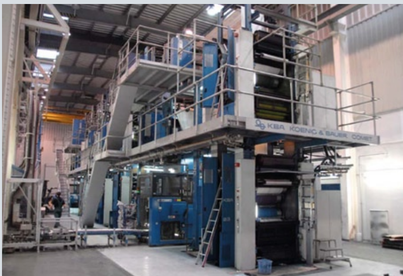
Печать всех газет в типографии «ПраймПринт Москва» ведется на рулонной печатной машине KBA Cometa
