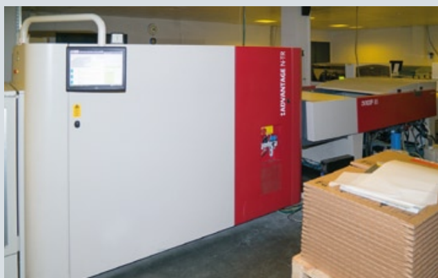
Недавно на предприятии установили новую скоростную систему СТР Agfa Advantage N-TR, позволяющую на пластинах Agfa N94-V изготавливать до 300 форм в час
