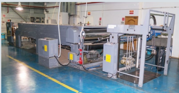
Есть в типографии и весьма редкое оборудование, в частности, линия для каландрирования оттисков и машина для вклеивания окошек из разных полимерных материалов
