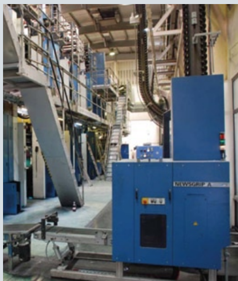
Печать всех газет в типографии «ПраймПринт Москва» ведется на рулонной печатной машине KBA Cometa
