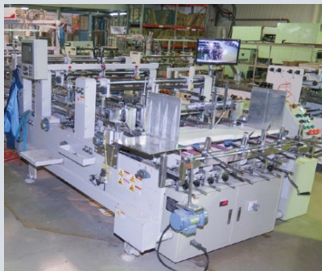
Все основные послепечатные процессы (тиснение фольгой, вырубка, фальцовка-склейка) в «Астролоне» выполняются на оборудовании Revotec южнокорейской компании YoungShin
