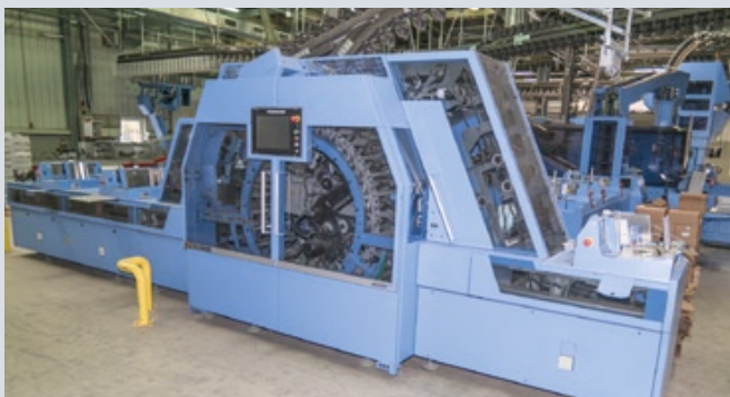
Комплектование газет из отдельных тетрадей и вложений проводится автоматически на линиях комплектования FlexiLiner и ProLiner от компании Muller Martini
