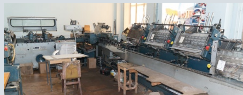
Вкладочно-швейно-резательный агрегат для производства изданий со скреплением на металлизированную скобу
