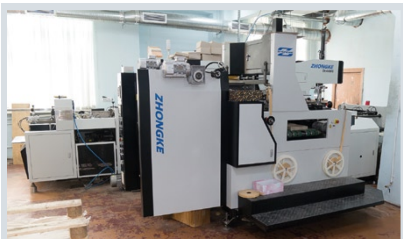
Автоматическая машина для производства жестких подарочных коробок ZHONGKE ZK-660FS. Выполняет оклейку картонного основания запечатанным лайнером
