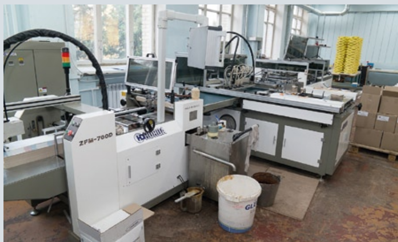
Машина HORDA ZFM-700D расширила возможности типографии в плане сборки составных крышек для жестких коробок, крышек с магнитами, игровых полей и крышек твердого переплета. Обе линии были поставлены компанией «ПринтПак»
