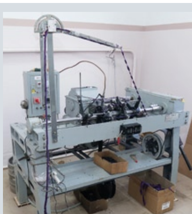
Оборудование для фиксации пластиковых наконечников на ленту, из которой изготавливают ручки к пакетам
