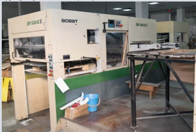
На автоматизированных вырубных прессах от компании Bobst выполняется вырубка заготовок и горячее тиснение фольгой
