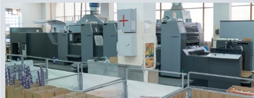
Машина Speedmaster CD 102-4-L-UV также работает по УФ-технологии, а на полуформатной Speedmaster SM 74-4 выполняются заказы с ВД-лакированием
