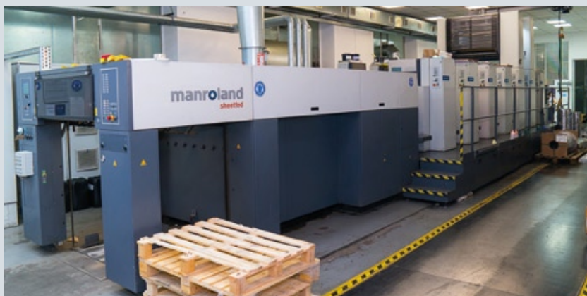
На полиграфкомбинате «Картон-Полиграф» выполняют много работ по непитьвающим материалам. Машина Roland 706 LV HiPrint оснащена для работы по УФ-технологии и позволяет в полной мере использовать ее преимущества в производстве поздравительных открыток, обложек для тетрадей и подарочной упаковки
