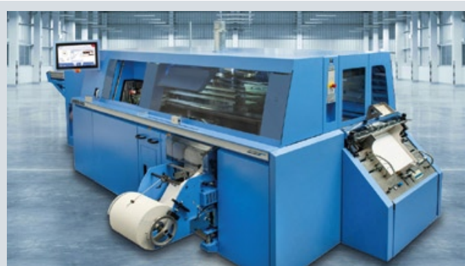
Машина клевого бесшвейного скрепления Varese от компании Muller Martini. В прошлом году в комплектации машины появилась опция для оклейки корешка блока без фрезерования
