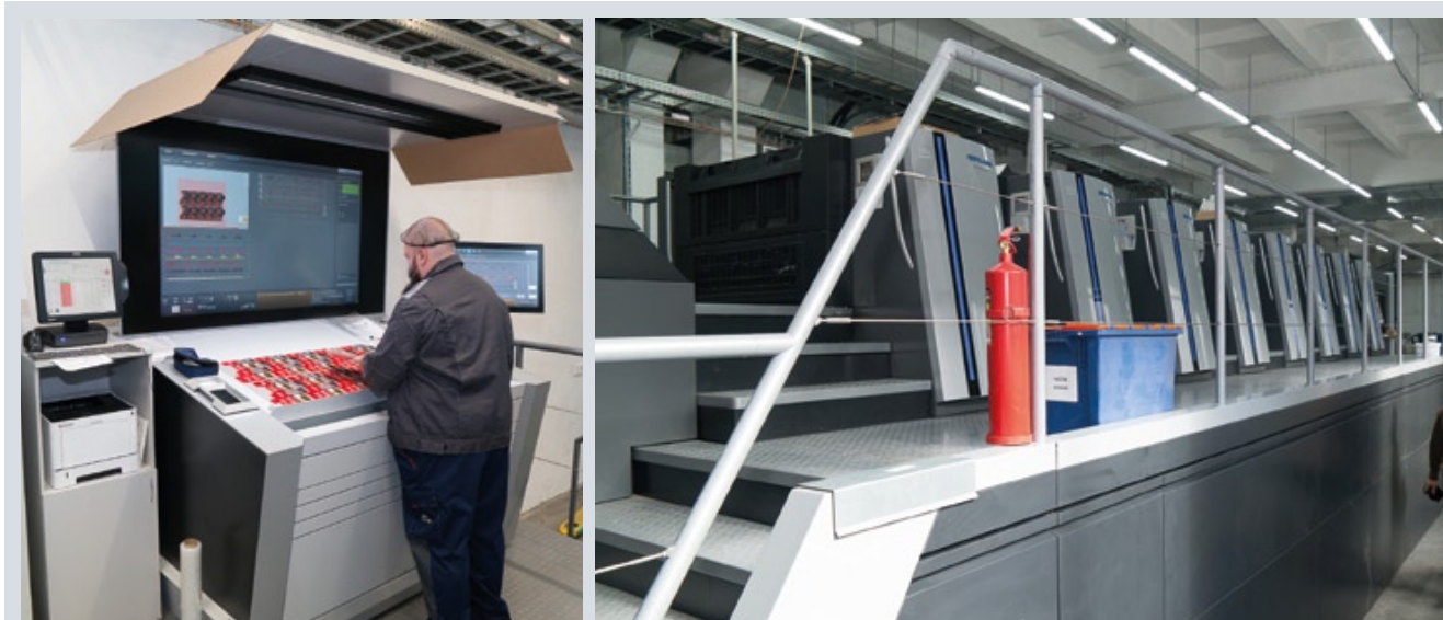
Машина Speedmaster XL 106-7+L предназначена для промышленной печати упаковки и оснащена самыми передовыми решениями в рамках концепции Push to Stop. В частности, системами спектрофотометрического контроля шкалы и видео-контроля изображения всего оттиска, автоматической системой логистики на самонакладе и приемке, а также системой для непрерывной подачи материала как на самонакладе, так и на приемке
