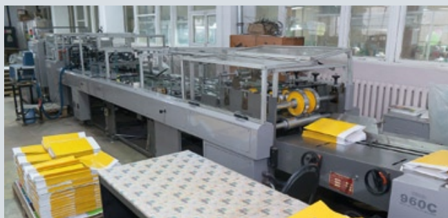
Линии Zenbo позволяют изготавливать пакеты различных форматов из крафт-бумаги, мелованной бумаги, белого картона
