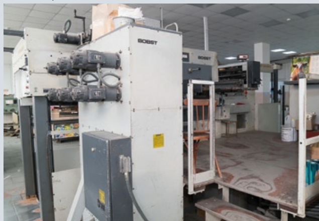
На автоматизированных вырубных прессах от компании Bobst выполняется вырубка заготовок и горячее тиснение фольгой
