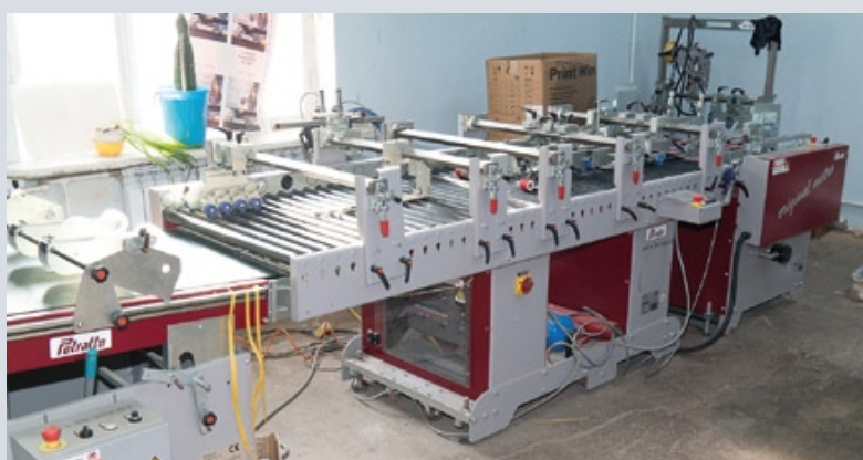
Фальцевально-склеивающая машина Petratto Merto-78 для производства картонных коробок с самоскладным дном
