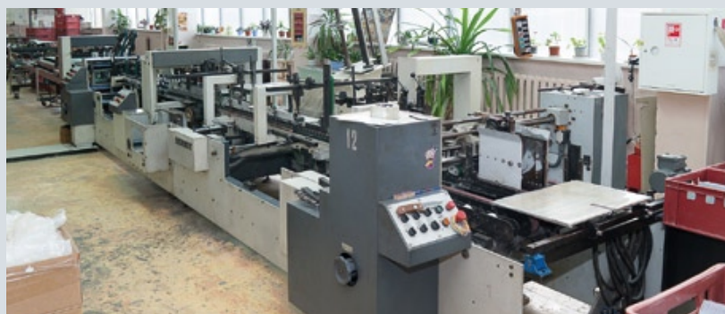
Фальцевально-склеивающая линия Bobst используется для производства подарочных картонных коробок
