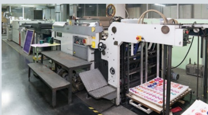
Трафаретная линия позволяет выполнять как сплошное лакирование, так и создавать фактурные покрытия
