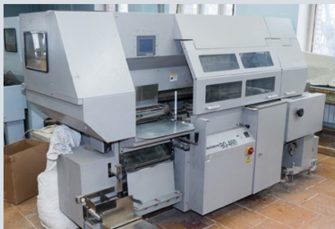
Оборудование компании Horizon для изготовления многостраничной продукции с клеевым бесшвейным скреплением
