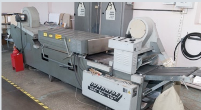
На термографических машинах выполняется декоративная отделка термоблестками и наносится объемная пластизол
