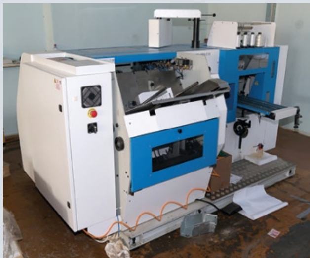
Ниткошвейная машина Smyth FF-240 для высокоскоростного потетрадного шитья книжных блоков, поставленная специалистами «Терра Принт»
