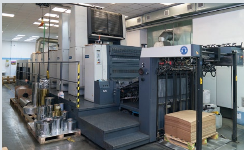
Шестикрасочная машина Roland 706 LV HiPrint оснащена навесной секцией холодного тиснения фольгой, что позволяет выполнять высококачественную декоративную отделку в линию с печатью
