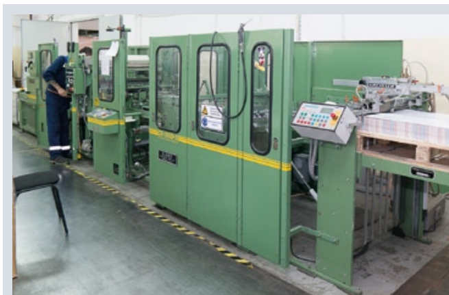
Автоматизированная линия Elsner Model CR-3150-S для смотки рулонов и упаковки их в термопленку позволила комбинату увеличить объем производства упаковочной бумаги
