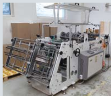
Высечка заготовок для стаканов осуществляется прямо из запечатанного рулона на специальных прессах для высечки с рулонной зарядкой. На фото справа машины для формирования стаканов и различных лотков для фаст-фуда
