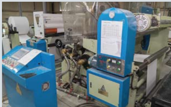
Флексографская машина для запечатки картона для стаканов, справа экструзионный ламинатор для полива картона
