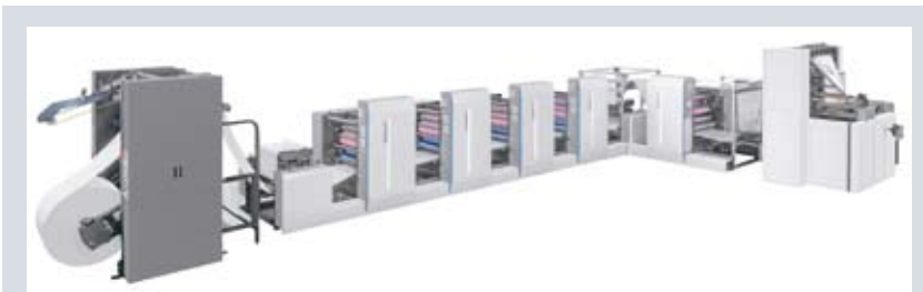
Рулонная офсетная печатная машина Luota для печати по бумаге
