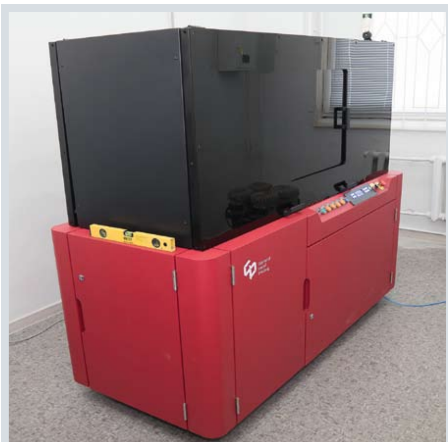
На производственной площадке Red Face Turbo специалисты компании «Танзор» и General Inkjet Printing произвели запуск цифровой машины GIP Cyclops. Она предназначена для многокрасочной печати с лакированием в линию по различным круглым, цилиндрическим и коническим изделиям с разрешением 1200 dpi. Её красочность: СМУК+белила+лак
