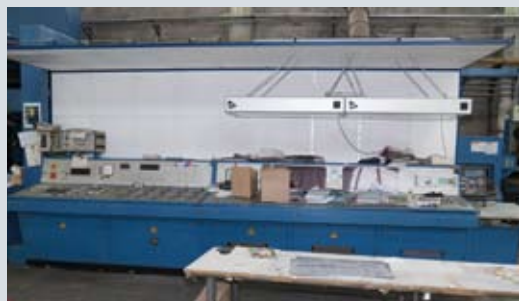
Рулонная машина с газовой сушкой Albert-Frankenthal 1015 позволяет быстро печатать многотиражную продукцию
