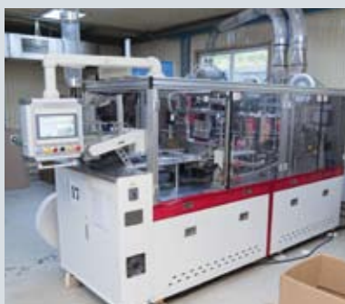
Высечка заготовок для стаканов осуществляется прямо из запечатанного рулона на специальных прессах для высечки с рулонной зарядкой. На фото справа машины для формирования стаканов и различных лотков для фаст-фуда
