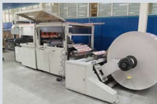
Высечка заготовок для стаканов осуществляется прямо из запечатанного рулона на специальных прессах для высечки с рулонной зарядкой. На фото справа машины для формирования стаканов и различных лотков для фаст-фуда
