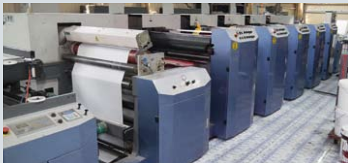
Флексографская машина для запечатки картона для стаканов, справа экструзионный ламинатор для полива картона
