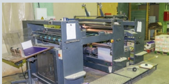
Большинство послепечатного оборудования в типографии поддерживает автоматизированную настройку по данным JDF
