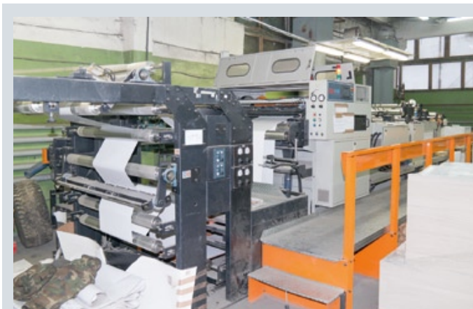
Нарезку бумаги на листы заданного формата для каждого заказа в типографии проводят на собственном флорезальном комплексе
