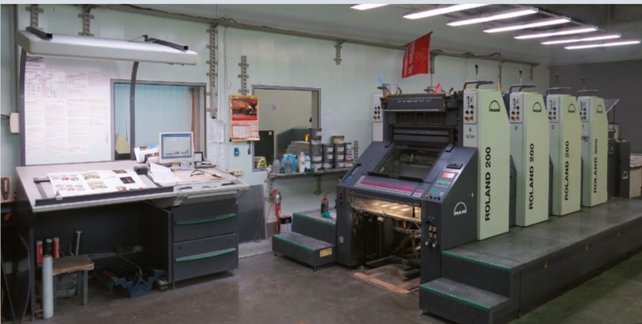
Рабочая лошадка типографии – офсетная печатная машина Roland 204E
