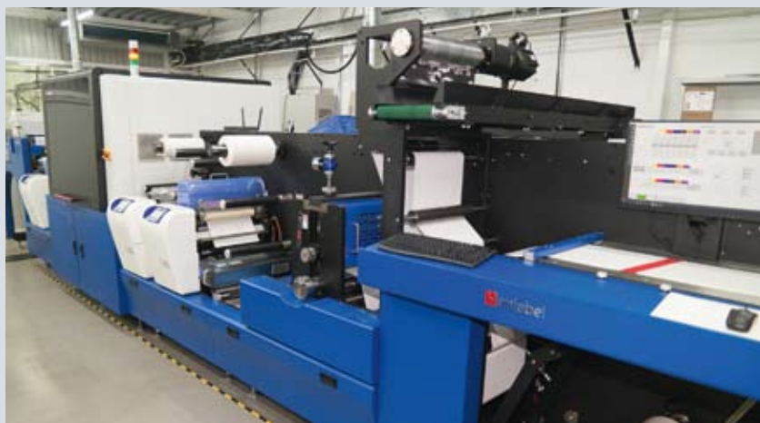
Инновационный гибридный печатно-отделочно-конвертинговый комплекс для производства этикетки LabStar 330S Hybrid
