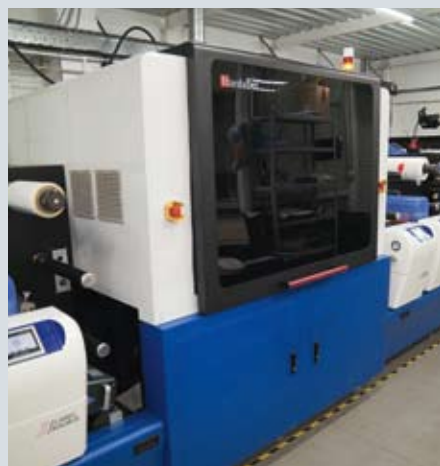
Инновационный гибридный печатно-отделочно-конвертинговый комплекс для производства этикетки LabStar 330S Hybrid
