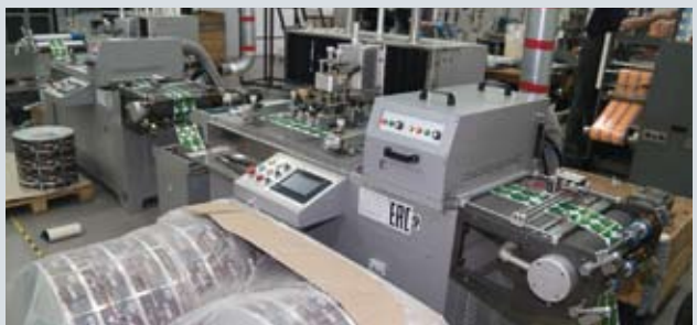
Линия отделки этикеток (тиснение плюс трафарет)
